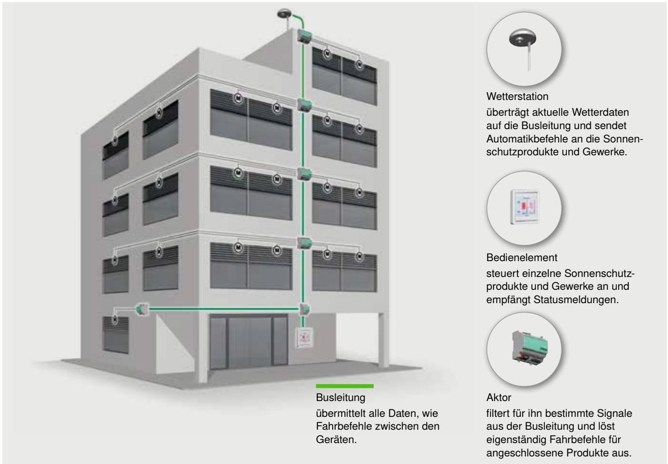
Fahrbefehle und Wetterdaten werden über die sogenannte Busleitung übermittelt. Die Messwertgeber übertragen aktuelle Wetterdaten an die Steuerzentrale oder direkt auf die Busleitung. Jeder Aktor filtert die für ihn bestimmten Signale der Busleitung und löst eigenständig Fahrbefehle für alle angeschlossenen Produkte (Sonnenschutz, Licht, Fenster etc.) aus.
