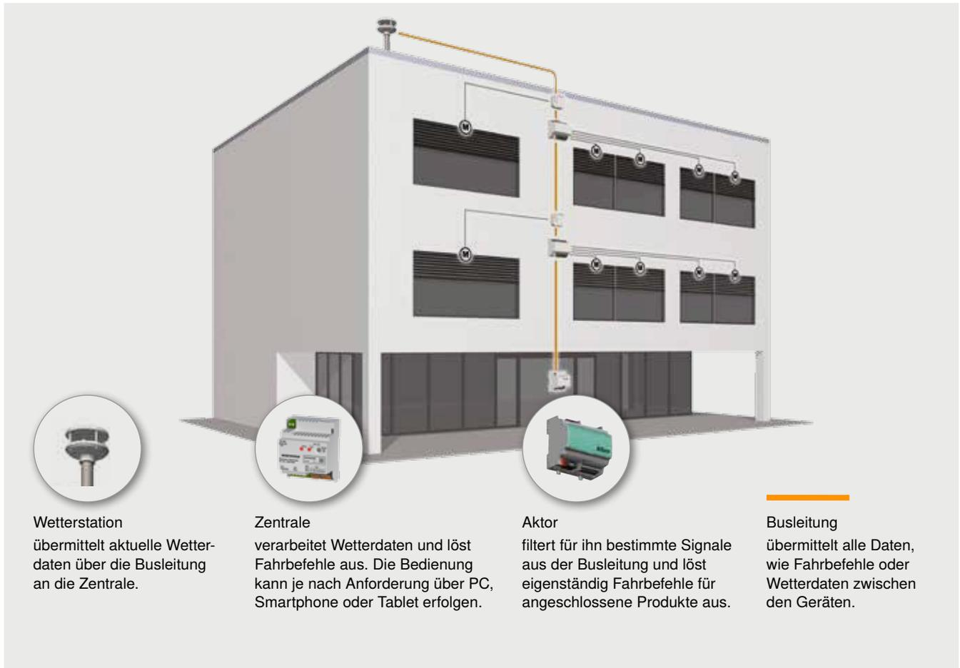
Fahrbefehle und Wetterdaten werden über die Busleitung übertragen. Die Omnexo Wetterstationen übermitteln aktuelle Wetterdaten an die Zentrale. Jeder Aktor filtert die für ihn bestimmten Signale aus der Busleitung und löst eigenständig Fahrbefehle für alle angeschlossenen Produkte aus.
