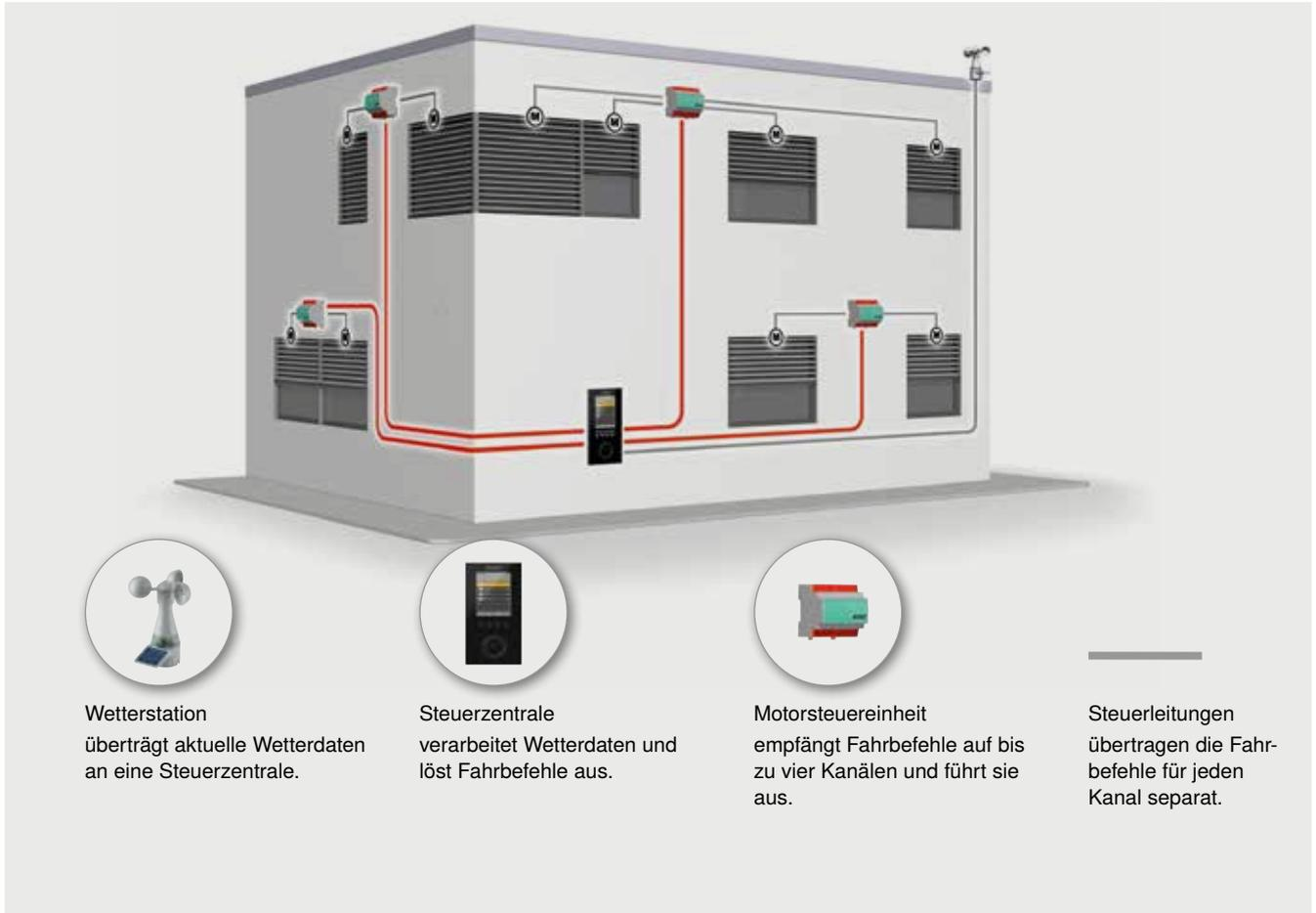
Fahrbefehle werden über separate Steuerleitungen pro Kanal übertragen. Messwertgeber übermitteln aktuelle Wetterdaten an die Zentrale, welche die Daten verarbeitet und automatisch Fahrbefehle auslöst. Die Fahrbefehle werden auf bis zu 4 Kanälen an Motorsteuereinheiten (MSE) übermittelt. Alle am angesteuerten Kanal angeschlossenen Produkte (Sonnenschutz und Licht) führen den Fahrbefehl aus.
